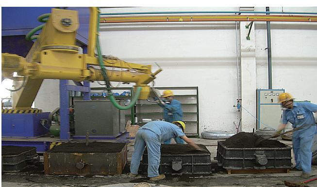
■ 15吨树脂砂双臂连续混砂机砂机
