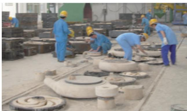
■ 铸造工人在认真的打磨砂型
